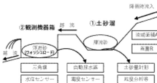
図一 土砂観測簡易施設概要図
