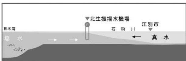
毎年7月から8月の大潮の時期には、海水が約18km上流にまで真水の下にくさび状に潜り込み、南西の風が強くなると界面摩擦により塩分が真水に混ざり込み、塩分濃度が上昇することが分かりました。
