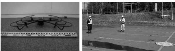
写真-1 3次元点群測量に用いたUAVと現地作業状況
