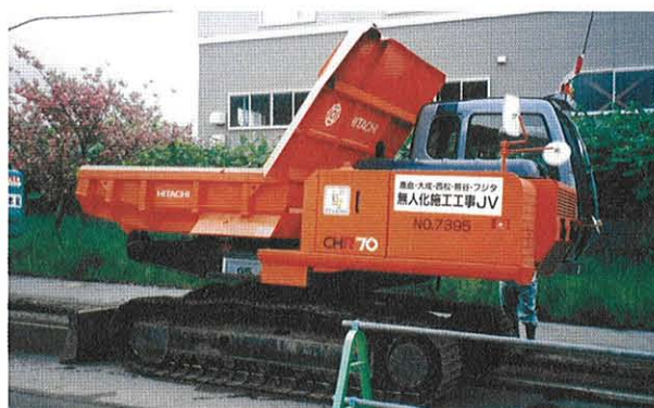
写真12 不整地運搬車7.0 t 級 CHR70
