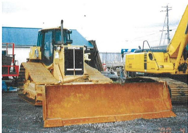
写真9 湿地ブルドーザー D6M
