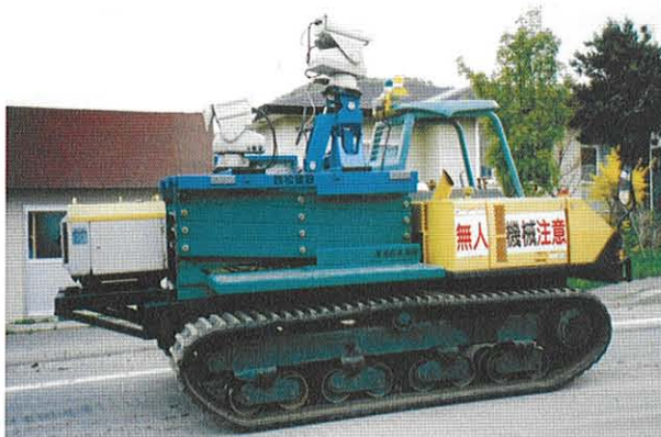
写真3 補助カメラ車 4 t 級不整地運搬車
