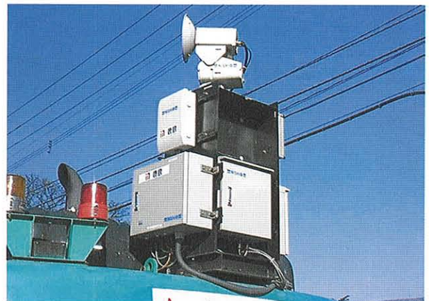
写真6 簡易無線システム 遠距離仕様
