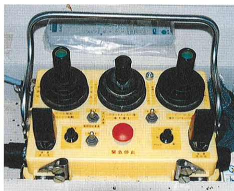
代表的な操作機（ヘトロニック社製） 特定省電力無線において、操作機と無線機に分離し外部アンテナ方式が可能である
