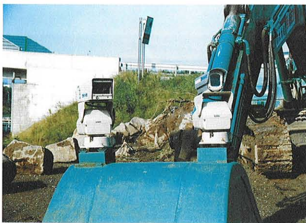
写真5 ズームカメラ 倍率21倍
