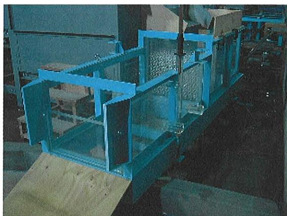
写真-2 流量測定堰
