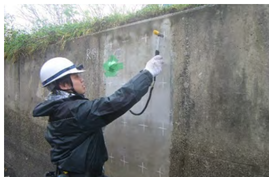
図-17 衝撃加速度計内蔵コンクリートテスターと調査状況
