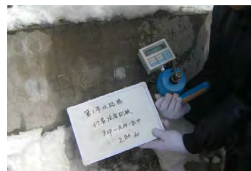
図-14 建研式引張試験機と調査状況
