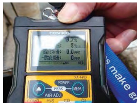
写真－６ ガス測定状況
