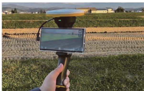
写真-3 AR機器での確認状況
