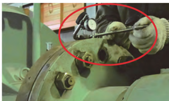
写真-1 芯振れの測定
