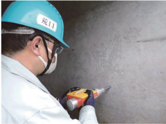
写真－8 シュミットハンマーによる強度試験
