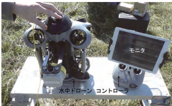
写真-2 使用した水中ドローン
