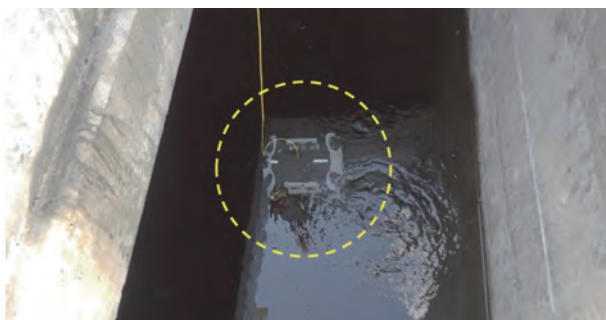
写真-3 水中ドローン使用状況
