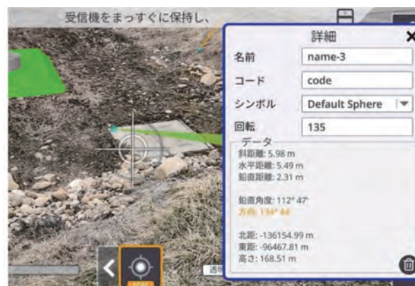
写真-8 AR機器のEDM機能による 位置及び標高計測
