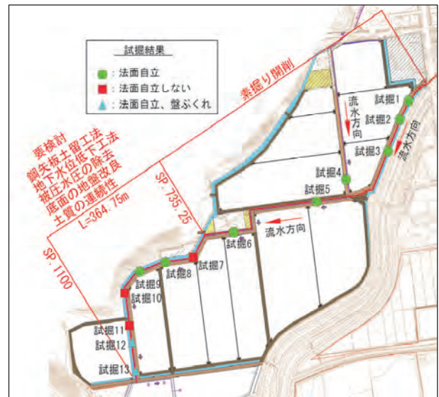
図-4 試掘結果による施工方法と課題
