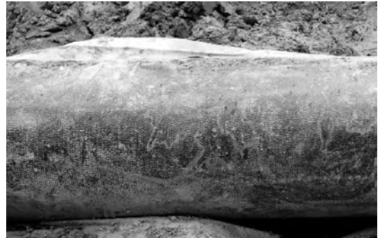
写真-10 ポリエチレンスリーブ被覆の管体
