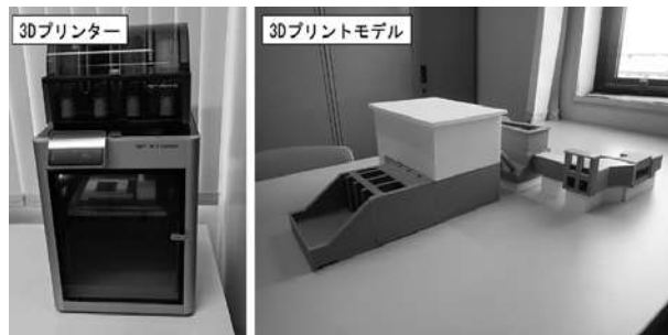
写真-3 3Dプリンター(株式会社バンブーラボ X1-Carbon)と土木構造物3Dプリントモデル(暫定版)
