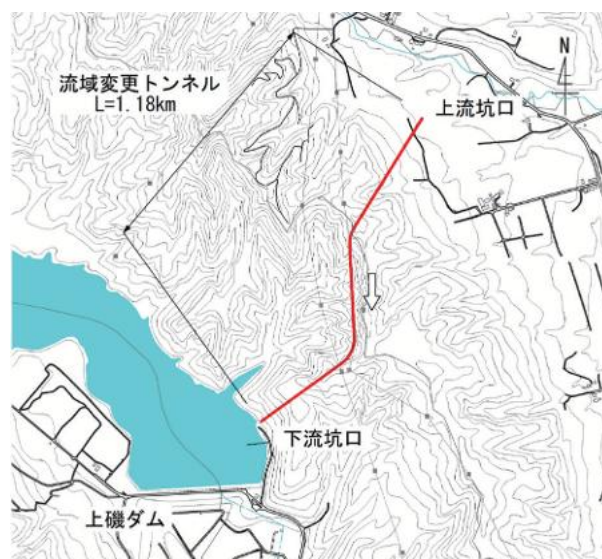
図-4 トンネルの平面線形
