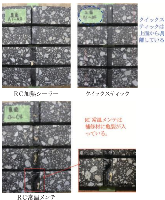
写真-9 曲げ疲労試験-試験後の供試体の状態
