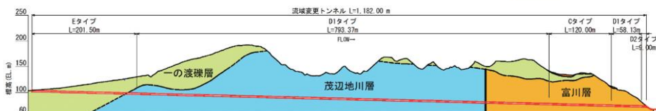
図-3 地質縦断面図とトンネルタイプ
