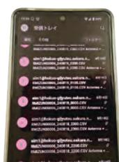
写真-9 遠隔監視装置からの測定値を受信（左：スマートフォン、右：パソコン）
