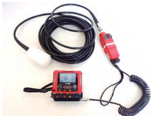
写真－17 ガスモニター
