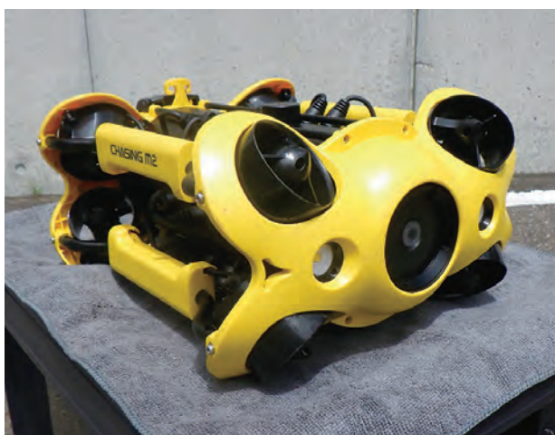
写真－２ 使用した水中ドローンの機体
