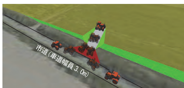
図－20 取付道路（車道幅員 4.0m）すれ違い状況
