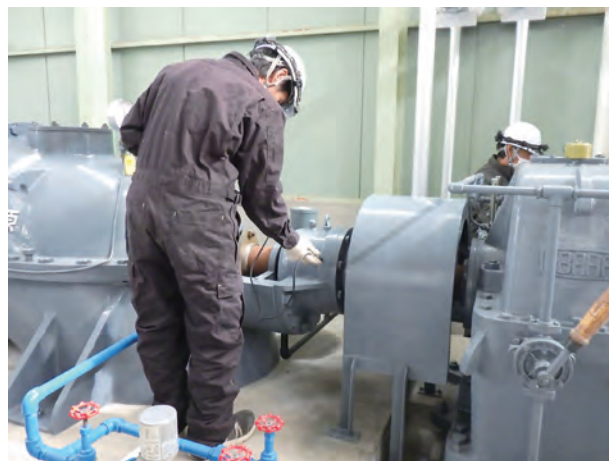
写真－３ 主ポンプ軸受部 振動計測
