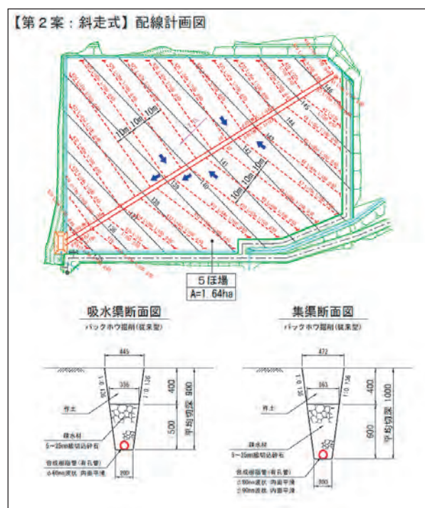
図-19 【第2案：斜走式】暗渠配線図
