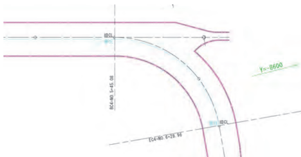
図－11 当該工区の合流工形状
