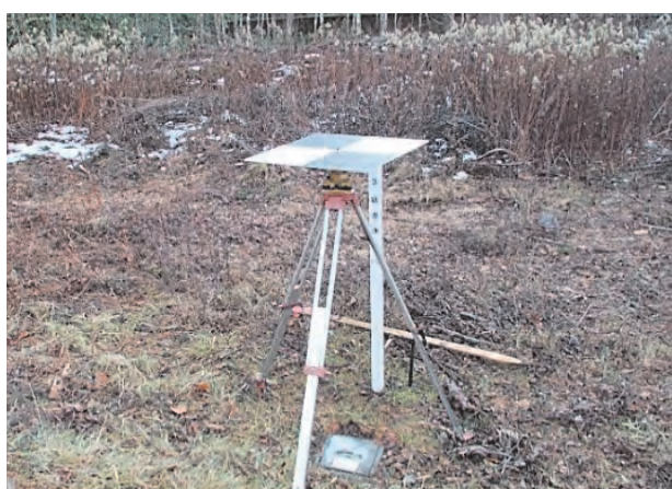
写真－６ 標定点対空標識設置状況（３級基準点）
