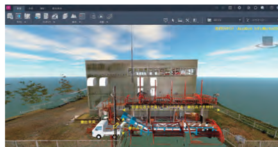
図-19 三次元モデル投影によるコンベヤ構造の検討
